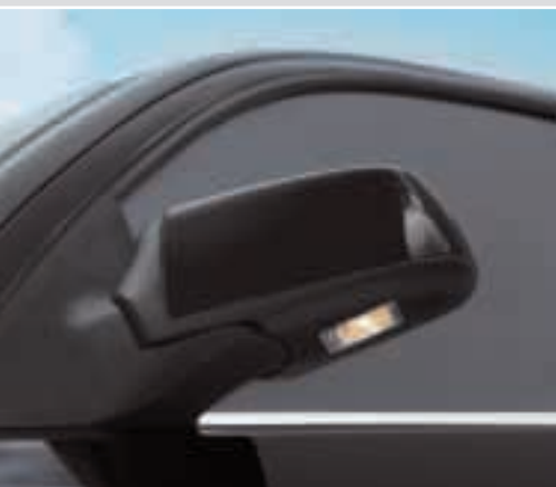
Külső visszapillantó tükrök A megnövelt külső visszapillantó tükrök minden modellnél javítják a hátrafelé való kilátást, ugyanakkor a beépített segédvilágítás és a tükör motoros behajtása bizonyos modelleknél tovább fokozza a kényelmet.
