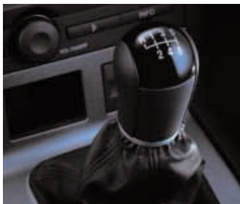
Hatfokozatú, kézi működtetésű sebességváltó Az új, hatfokozatú sebességváltó a fokozatok közötti nagyobb rugalmasságot és a nagyobb potenciális végsebességet kedvezőbb üzemanyag-fogyasztással és kultúraltabb működéssel ötvözi.
