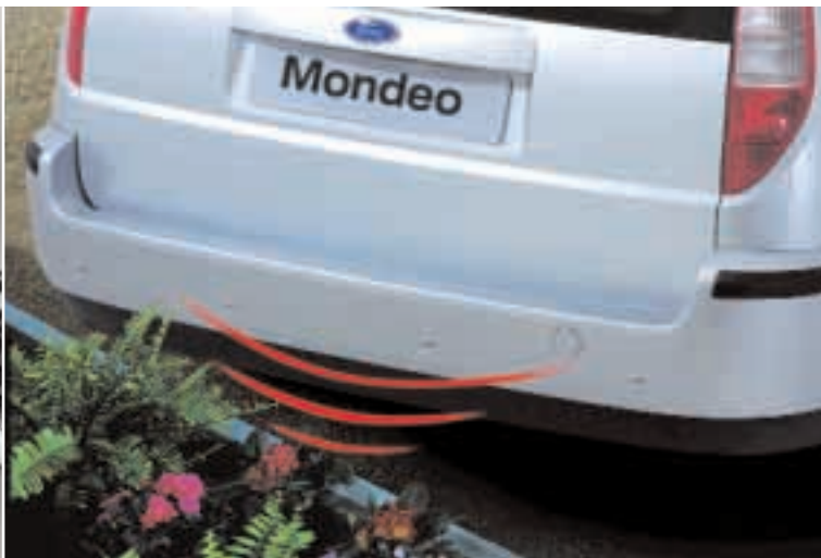
Parkolóradar A hátsó lökhárítóban elhelyezett érzékelők segítenek dönteni a nehéz parkolási helyzetekben.*
