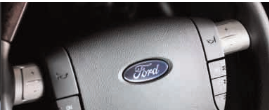
Durashift 5-tronic Az opcionális Durashift 5-tronic automata sebességváltó most a kormánykerékbe integrált gombokkal akár ujjhegygel is vezérelhető.
