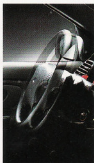
A kormánykerék dőlésszögét és magasságát szabályozó kormányoszlop (alapfelszereltség minden modellen)
