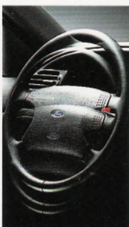
A kormánykerék dőlésszögét és magasságát szabályozó kormányoszlop (alapfelszereltség minden modellen)
